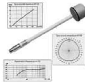
FIGURA B.1.8 Esempio di sonda isotropica triassiale a larga banda per la misura di campo elettrico.
