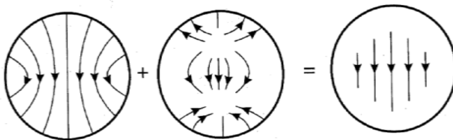
FIGURA B.4.14. Combinazione modo TE_{11} (a sinistra) e TM_{11} (al centro) ed illuminazione risultante (a destra).
