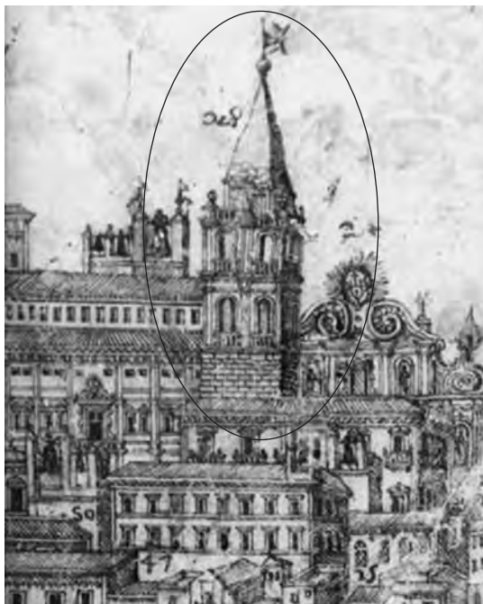
17. Trapani, P. Marconi con G. Della Longa, M. Zampilli, P. Maltese (Direttore dei lavori): il restauro di Palazzo Riccio di San Gioacchino (1999/2009, per conto della Provincia Regionale di Trapani). Un disegno seicentesco della torre utile per la ricostruzione in muratura e legno della cuspide.
