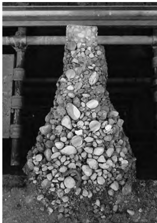
45. Vicenza, Basilica Palladiana: pessimo assortimento della granulometria della ghiaia.
