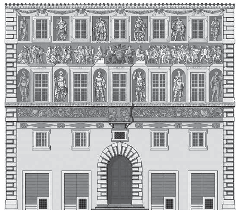
2. Disegno ricostruttivo del fronte del palazzo di via Giulia nella seconda metà del XVI secolo: la decorazione è articolata secondo la descrizione che ne dà Letarouilly e al piano terreno si aprono le porte delle botteghe verso via Giulia (elaborazione dell'Autore).
