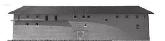
7. Rilievo del Whenchang Lou con spaccato assonometrico, l'ultimo tulou costruito nel villaggio di Tianluokeng. Ha pianta ovale e copre una superficie di 2.210 metri quadrati. Si compone di 32 camere su ciascuno dei tre piani, con due scale comuni poste alle due estremità dell'edificio. La galleria dà accesso a ogni unità abitativa. La sezione trasversale mostra come ogni piano sovrasta quello sottostante per ottenere una migliore protezione dalle forti piogge e dal sole creando una galleria ombreggiata.
