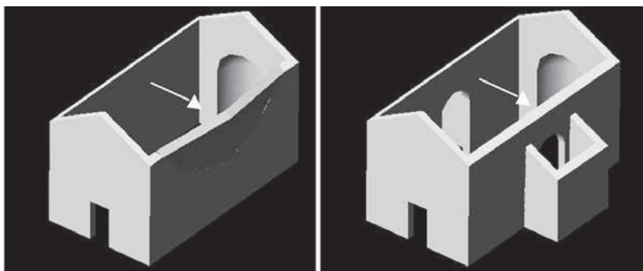
9. Aggiunta di cappelle laterali nelle chiese a navata unica funzionale alla stabilità delle pareti perimetrali.
