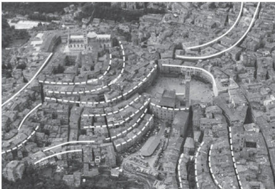
13. Siena: criticità determinate dalla conformazione planimetrica degli aggregati edilizi in relazione alla configurazione di pendio (concavità e convessità del lato a valle).
