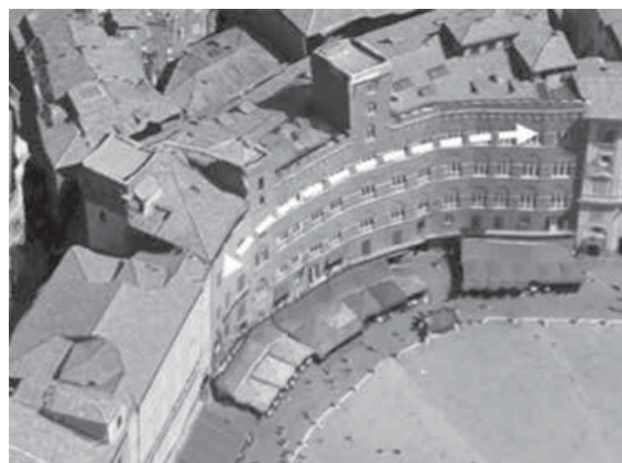
5. Siena, Piazza del Campo: esempio di aggregato edilizio ad impianto concavo su lato a valle e dell'effetto diga di contenimento che si genera spontaneamente.
